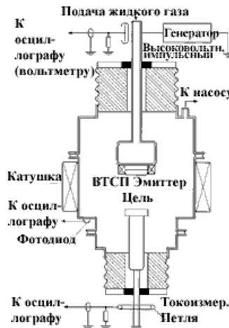
**Окончательный вариант** разрядной камеры представлен на рисунке. (Прибор показан вертикально, хотя фактически был расположен горизонтально).
